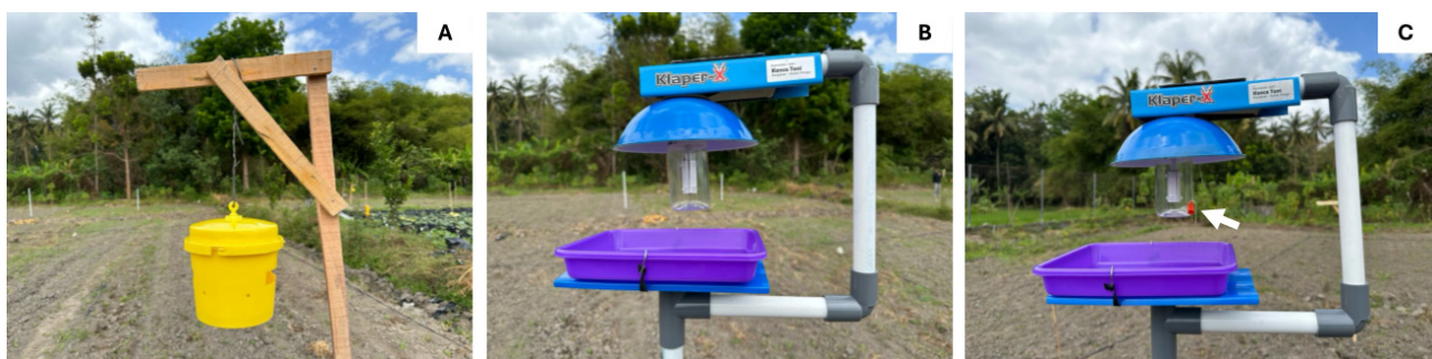
Gambar 1. Perangkap yang digunakan untuk memantau Spodoptera frugiperda pada pertanaman jagung dan padi. A: perangkap feromon (F); B: perangkap cahaya (C), dan C: perangkap feromon–cahaya (FC). Panah putih menunjukkan posisi feromon pada perangkap feromon–cahaya (Gambar C).
